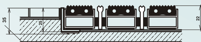
hlbka stavebného otvoru
